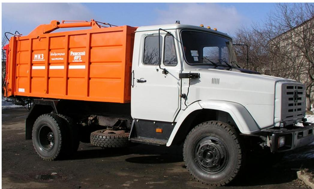
Рисунок 4.10.1 – Мусоровоз кузовной с задней загрузкой
