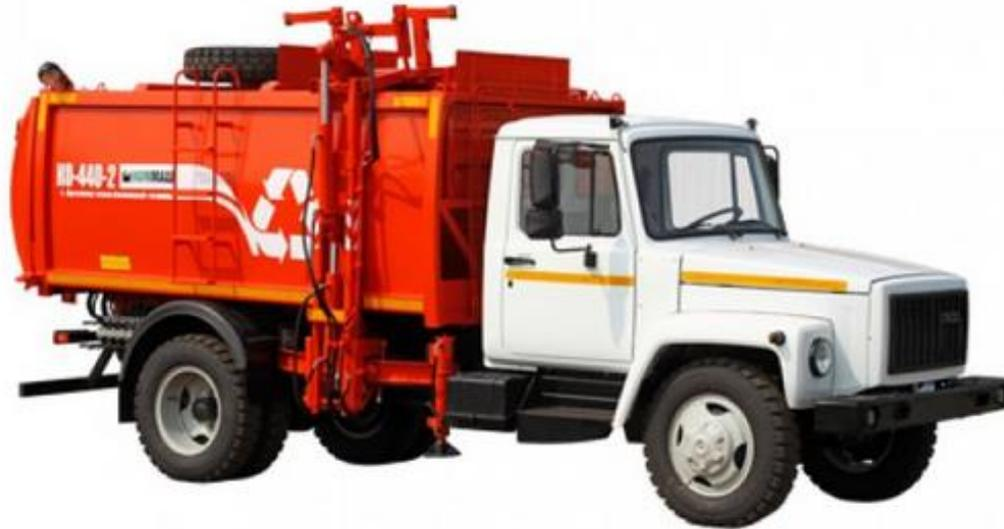
Рисунок 4.10.2 – Кузовной мусоровоз с боковой загрузкой кузова манипулятором
